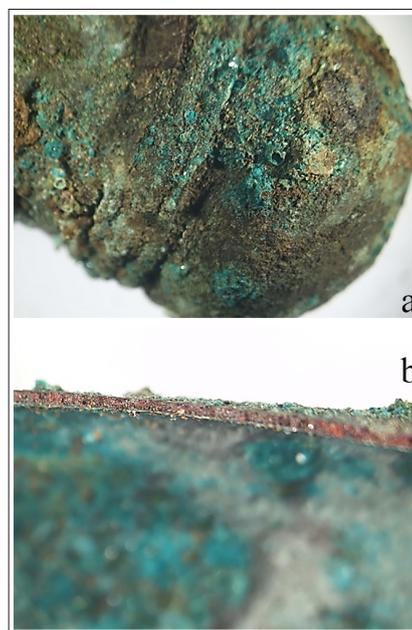
**Fig. 4.** M 200X, crustă grosă (secundară) și miez metalic parțial mineralizat, formațiuni de acoperire în relief.
