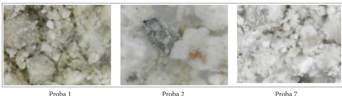
**Fig. 11.** Fotomicrografiile ale probelor de mortar de tencuială din zidurile fortificației medievale (secolul al XIV-lea – Sectorul 71), OMX500.
